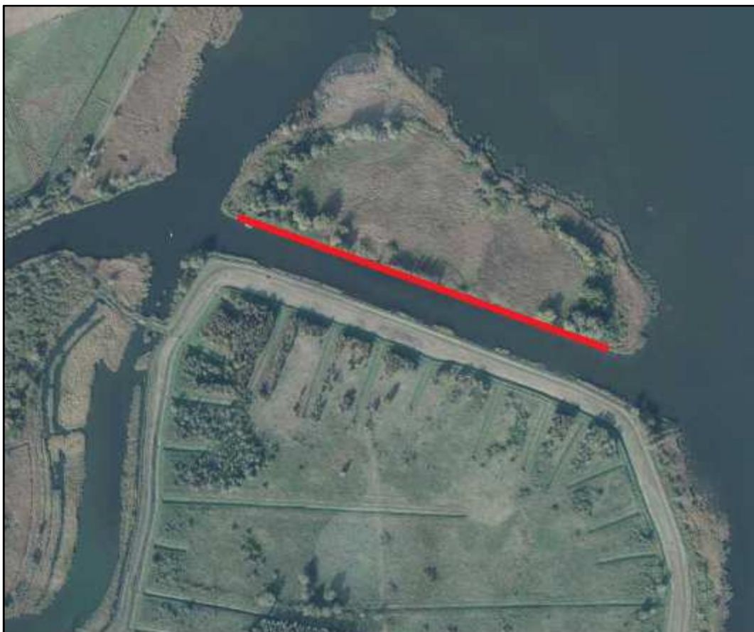
Rycina 9. Skarpa wyspy Kiełpiński Ostrów sąsiadująca od południa z Kanałem Kiełpińskim na tle ortofotomapy – obszar przewidziany do umocnienia
